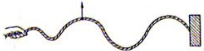
Fig. 3. Movimiento de una cuerda que tiene uno de sus extremos fijo y el otro recibe un impulso.
